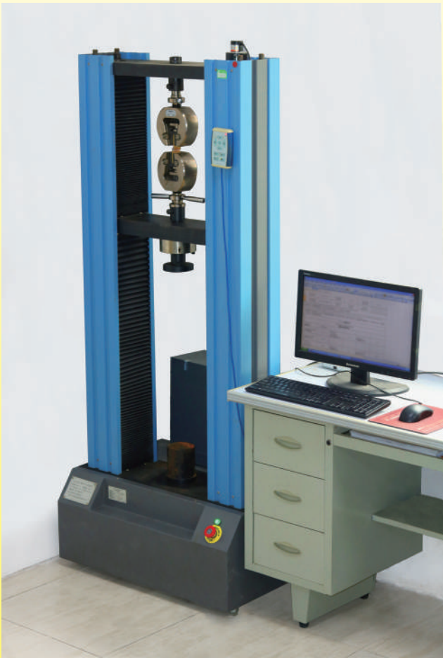
断裂抗张强度和延伸率的测试设备
